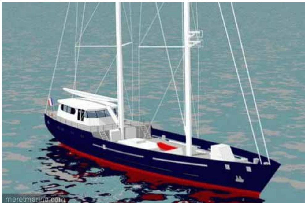
Vue du nouveau navire que souhaite commander CTMV Le futur bateau sera gréé en ketch (© : ENSIETA)
